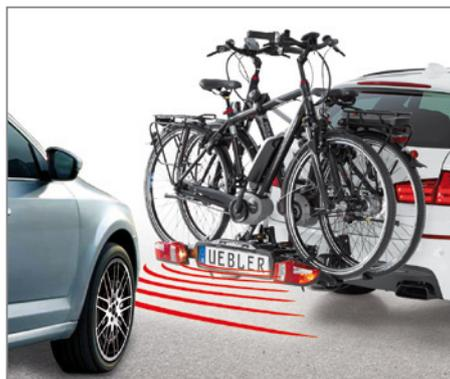
Beim Verbinden der elektrischen Anschlüsse des Trägers mit der Steckdose am Fahrzeug, wird der serienmäßig im Fahrzeug installierte Abstandswarner abgeschaltet.
