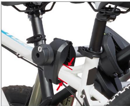
Sichere Befestigung – auch für Oversize-Rahmen und Ovalrohre (bis 75 mm Rundrohr oder 75 x 45 mm Ovalrohr).
