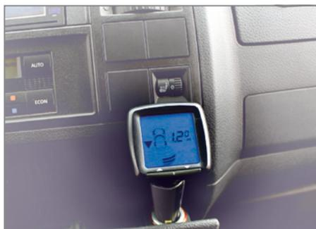
Eine gesonderte Verkabelung mit dem Fahrzeug ist nicht notwendig. Das Empfangs-Display wird einfach in den Zigarettenanzünder oder eine Bordsteckdose gesteckt und ist sofort einsatzbereit.
