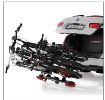
Der Träger kann im beladenen Zustand abgeklappt werden.
